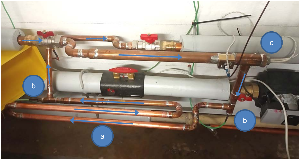
Abbildung 7-7: Messstrecke (a) mit Mantelthermoelementen (b) und elektrischem Heizstab (c); Hinweis: Aufgrund der besseren Anschaulichkeit ohne Wärmedämmung dargestellt
